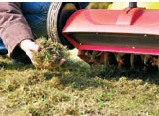
Der Vertikutierer entfernt den Rasenfilz und sorgt für mehr Luft.
